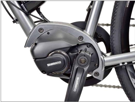
シマノ製 電動アシストコンポーネント「STePS(Shimano Total Electric Power System)」を採用。
